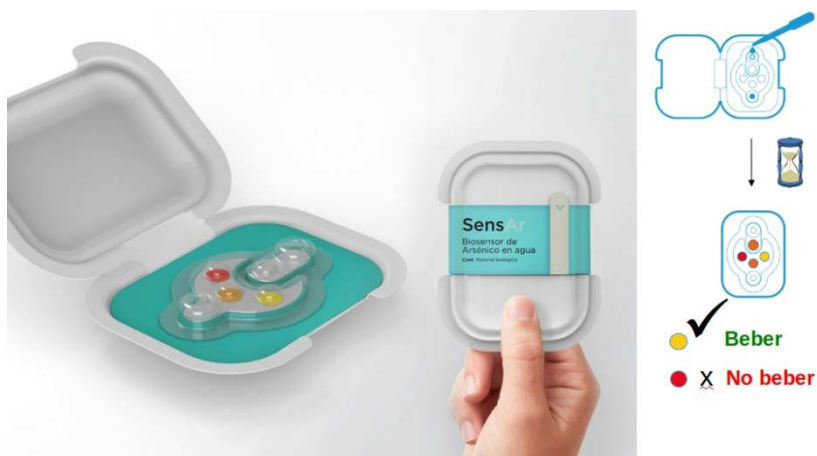
Figura 2. Prototipo del sensor de arsénico SensAR. El usuario debe colocar el agua a evaluar en un pocillo y agua limpia (incluida) en el posillo de referencia. Luego de unas horas se compara el color con la referencia y se distingue por contraste agua presentando menos (amarillo) o más (rojo) arsénico que el nivel de 50 microgramos por litro permitido por la OMS (naranja).
